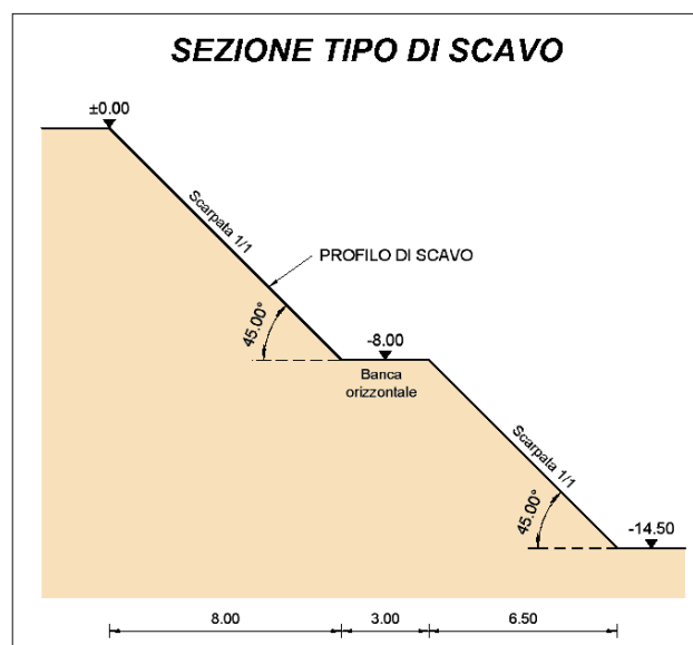
Figura 14 - Sezione tipo di scavo
