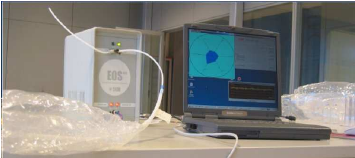
Figura 1: Sistema Olfattivo Elettronico da laboratorio abbinato a PC portatile per l'acquisizione dati (la figura geometrica sul monitor del PC è l'impronta dell'aria in esame, creata dal naso elettronico, rappresentante la risposta dei sensori al campione di aria sottoposto ad indagine).
