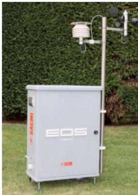
Figura 7: Apparato olfattometrico EOS507 di SACMI
